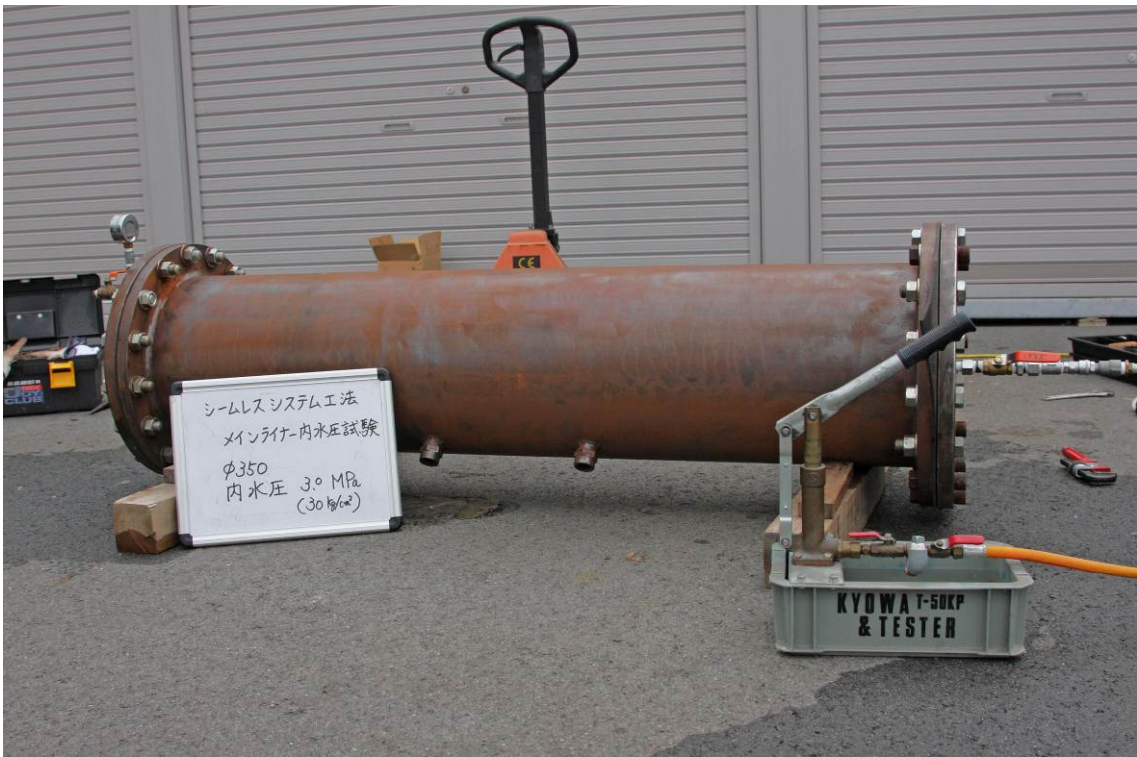
写真-8 開口部状況 (漏水なし: 3.0MPa)
