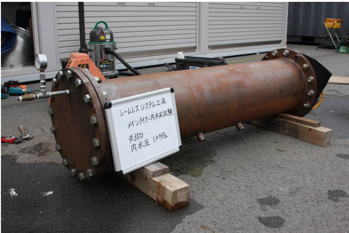
写真-4 開口部状況 (漏水なし: 1.0MPa)
