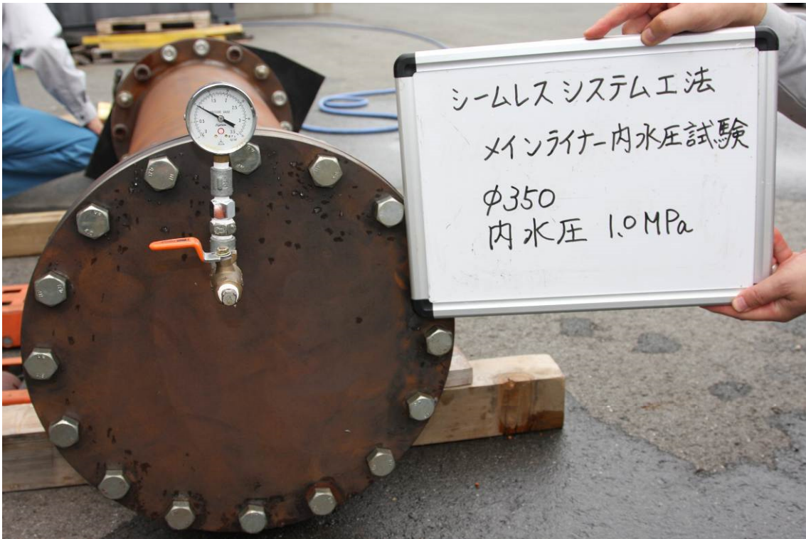
写真-3 試験状況 ゲージ圧1.0MPa
