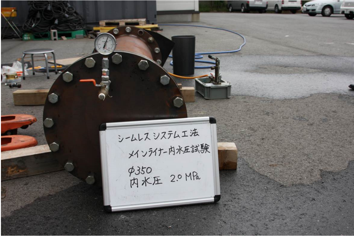
写真-5 試験状況 ゲージ圧2.0 MP a
