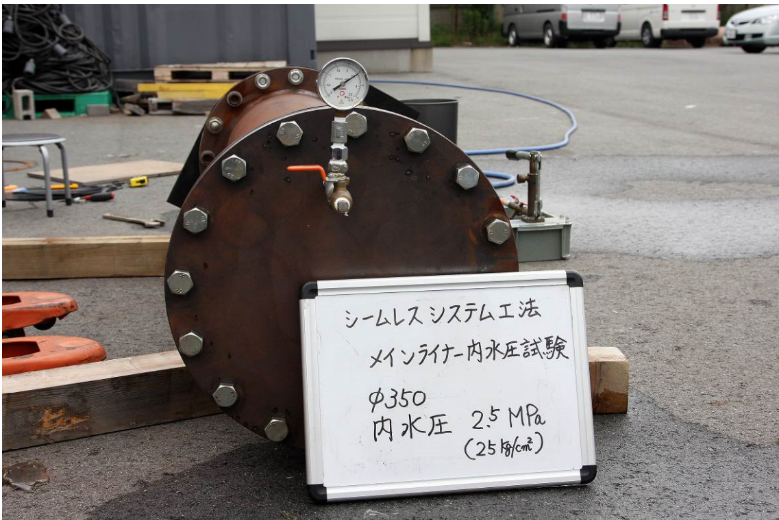
写真-6 試験状況 ゲージ圧2.5 MP a
