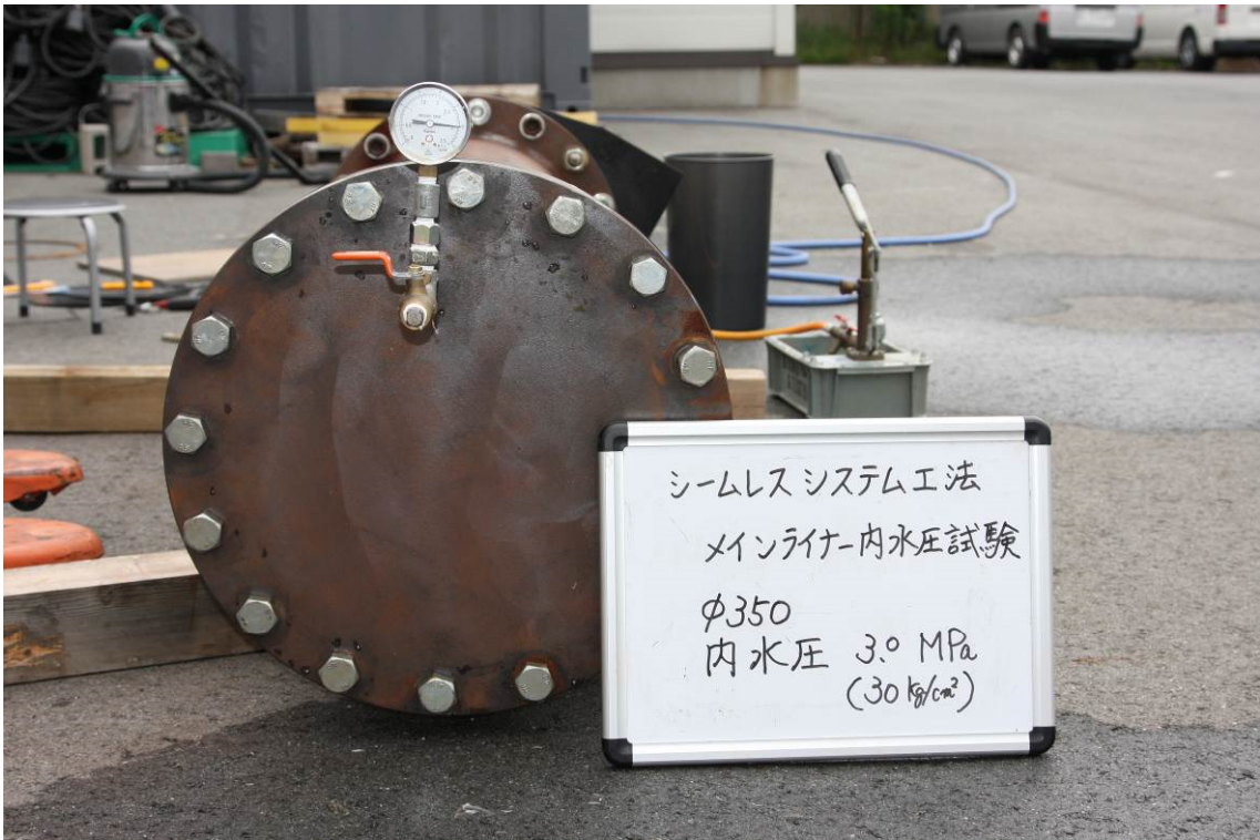
写真-7 試験状況 ゲージ圧3.0MPa
