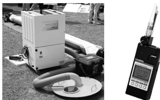
写真-5 粉塵回収・脱臭装置(左) 臭気計測器(右)
