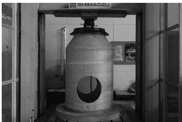
耐荷試験状況 (200kNで破壊しない!)
