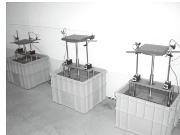
■写真1. アルファライナーの長期試験状況
