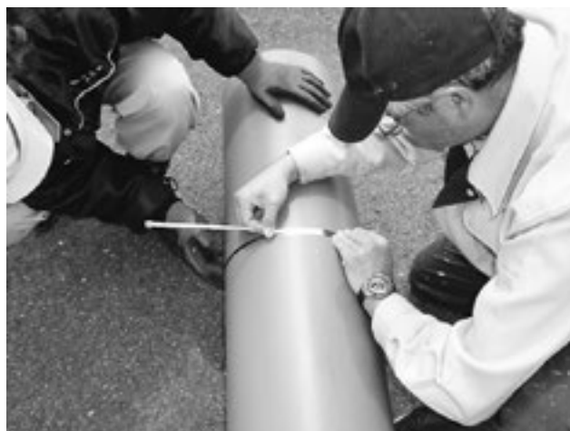
■写真5 π尺による平均直径測定
