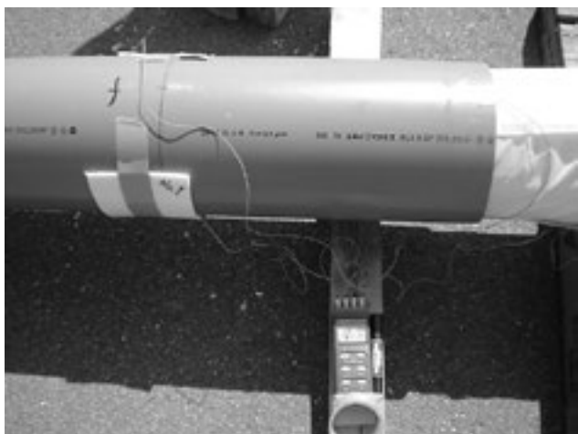
■写真4 測点 f の熱電対式温度計
