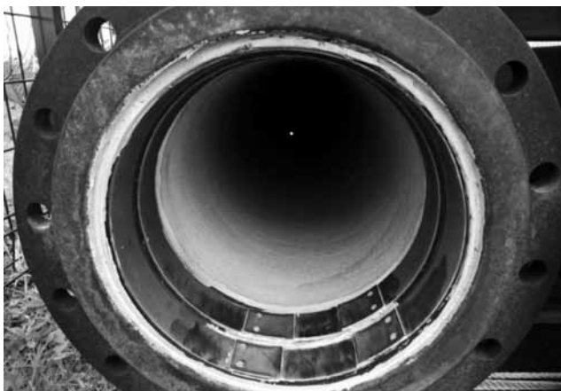
■写真3「端末処理工」5年間屋外暴露試験品 …実際は2011/11/02の写真 7年経過
