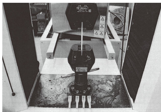
写真-3. 引張試験と試験片
