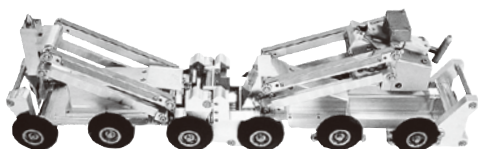
管内作業ロボット
